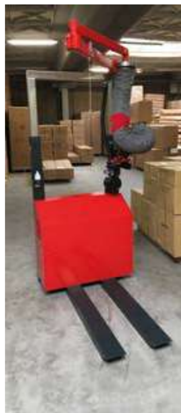
VERSION AUTONOME ENFOURCHABLE POUR CHARIOT ÉLEVATEUR
