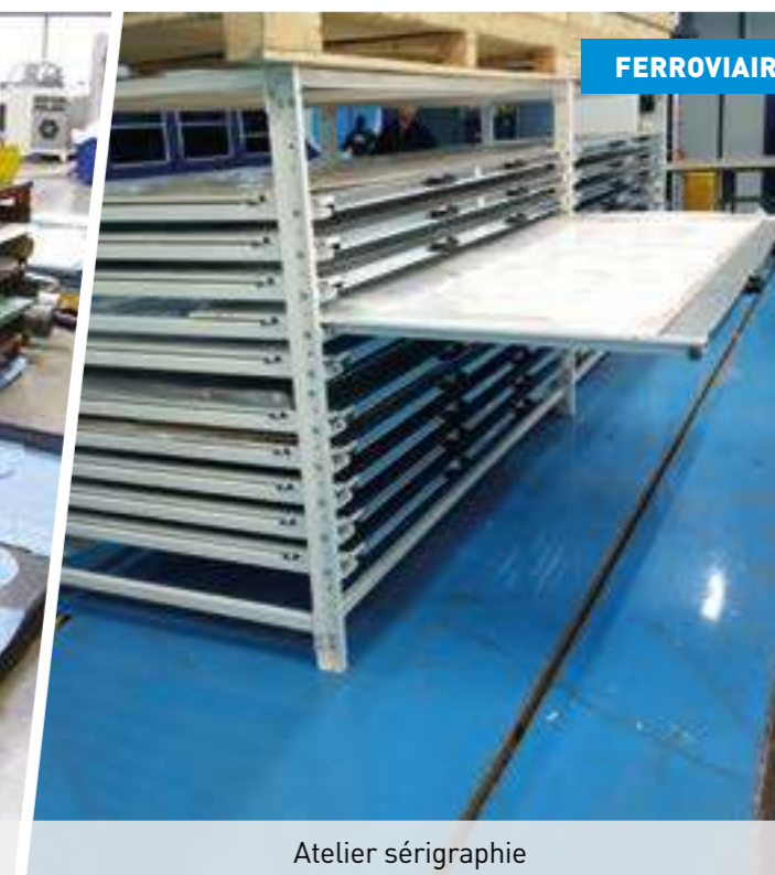
Stockage à plateaux extractibles, stockage agrès de manutention
