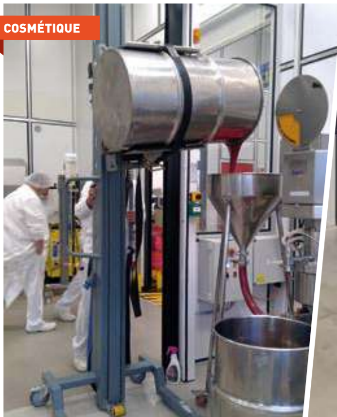
Actilift avec mât à hauteur spécifique et retourneur de fût
