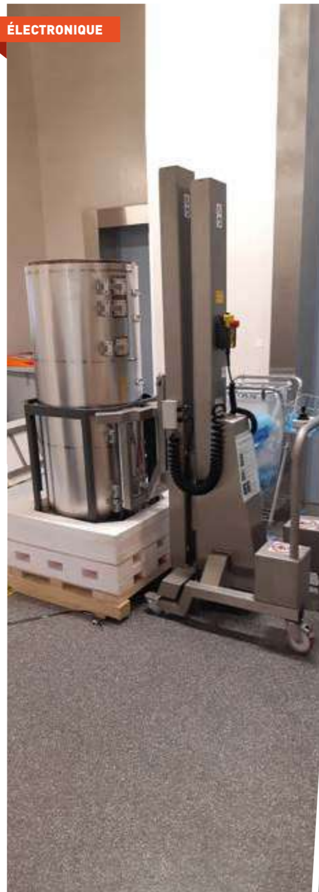
Mini gerbeur inox avec mat télescopique, contre poids et support fût
