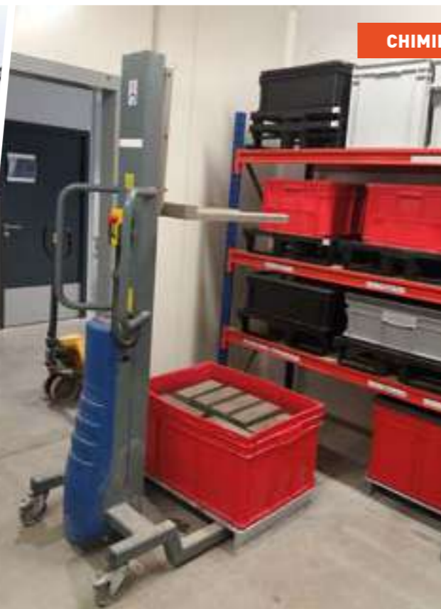
Actilift avec plateau spécifique pour manutention de caisse
