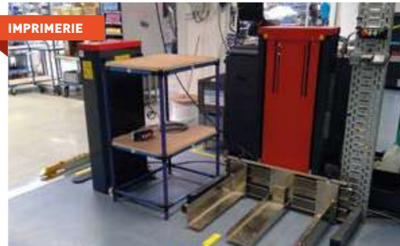
Accessoire triple fourches réglable en largeur pour embases dimensions variables
