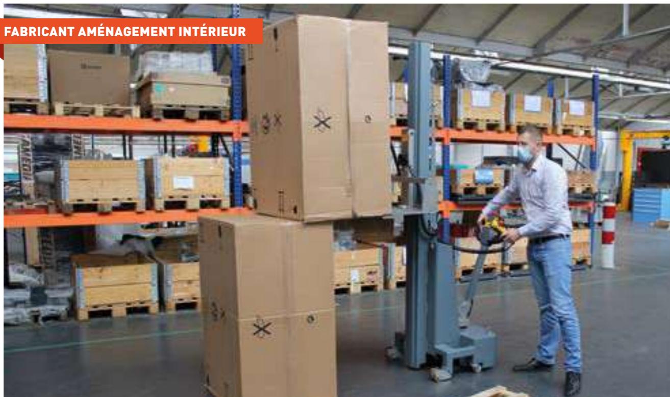
Actilift avec déplacement motorisé équipé d'un plateau pousseur de carton
