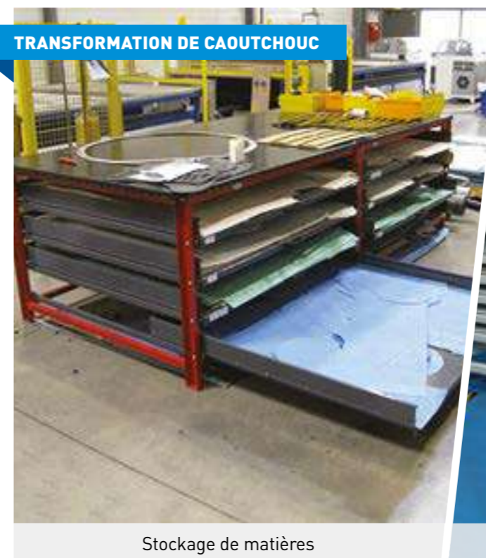
Stockage à plateaux extractibles, stockage agrès de manutention
