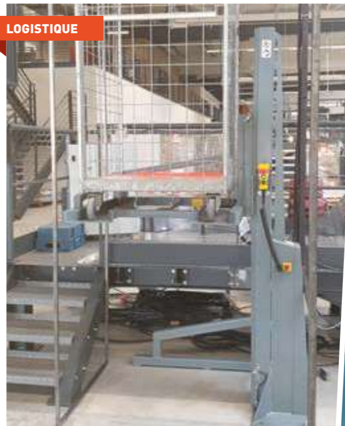
Actilift élévateur fixe avec fourche spécifique pour la mise à niveau de chariot roll
