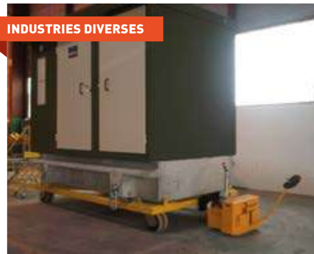
Avance poste à poste sur ligne de montage
