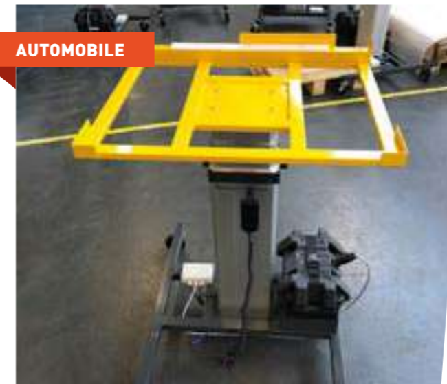
Poste d'assemblage à colonnes grande course pour mise en place de composants sous engines
