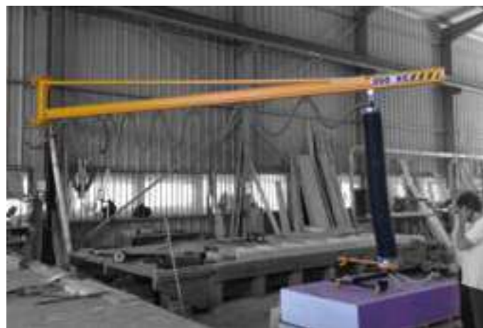
Palonnier multi-ventouse panneaux, poignée rallongée
