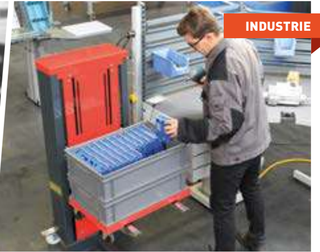
Mise à niveau de bacs accolés à un poste de travail
