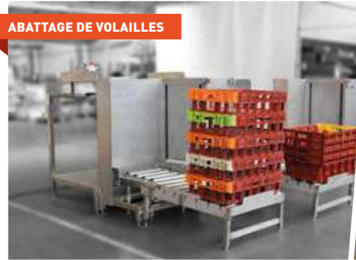
Empileur avec convoyeur intégré, ligne de conditionnement
