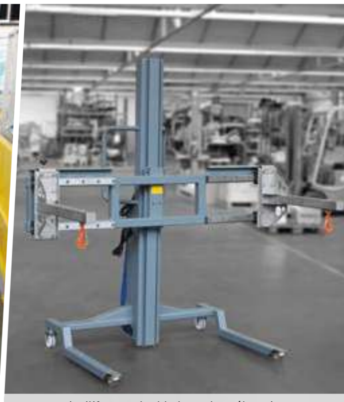
Actilift avec double bras de préhension réglable sur guidage linéaire
